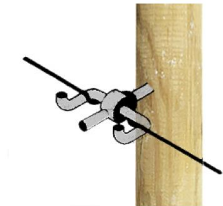
Abbildung: Stützpunkt mit Kabelträger aus Metall
