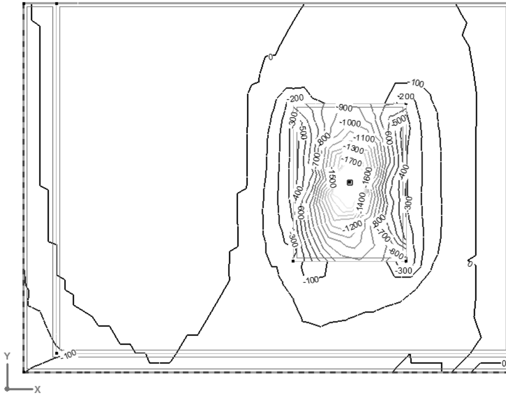
Biegemomente für untere Bewehrung in x-Richtung
